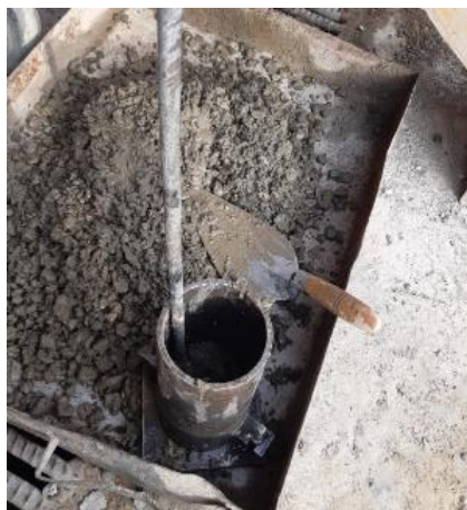
Figura 12. Colocación de la mezcla en los moldes.
