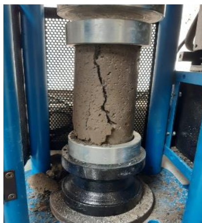
Figura 23. Rotura de cilindro sometido a Fuerza de compresión.
