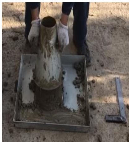
Figura 19. Desmolde de la muestra, (Tecnología del Hormigón UCB, 2017).
