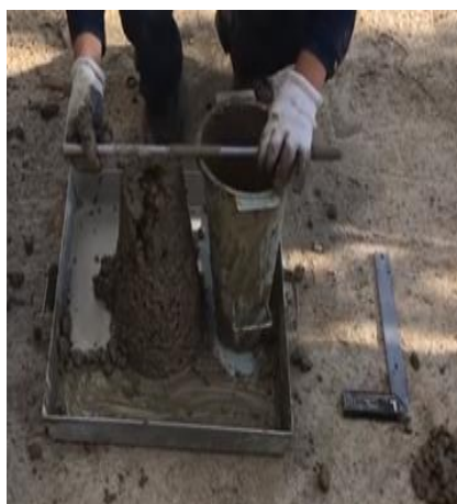
Figura 20. Medición de altura de asentamiento, (Tecnología del Hormigón UCB, 2017).
