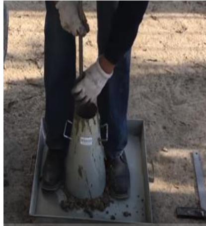
Figura 17. Compactación de la mezcla, (Tecnología del Hormigón UCB, 2017).
