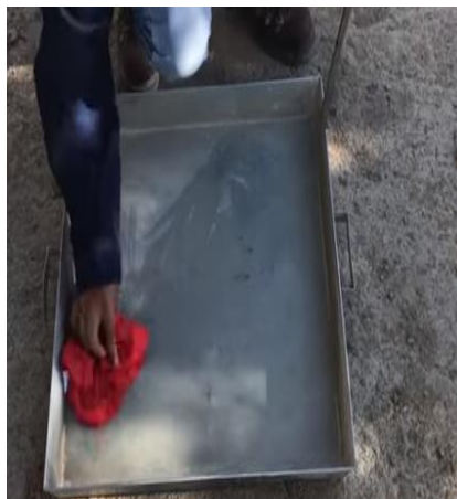
Figura 15. Preparación de los moldes, (Tecnología del Hormigón UCB, 2017).
