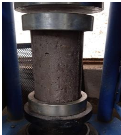
Figura 22. Colocación de la muestra en la máquina de ensayo a compresión.
