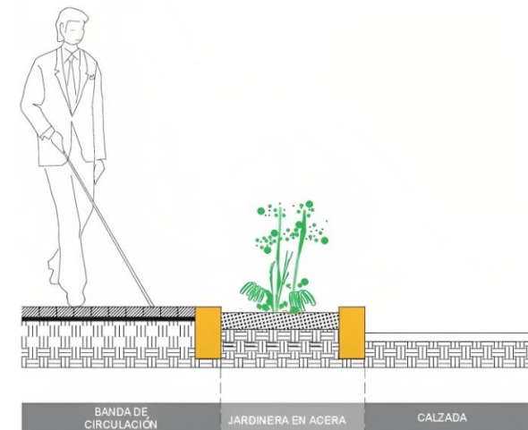
Figura 46. Bordillo de advertencia al nivel de vereda Fuente: INEN (2017)
