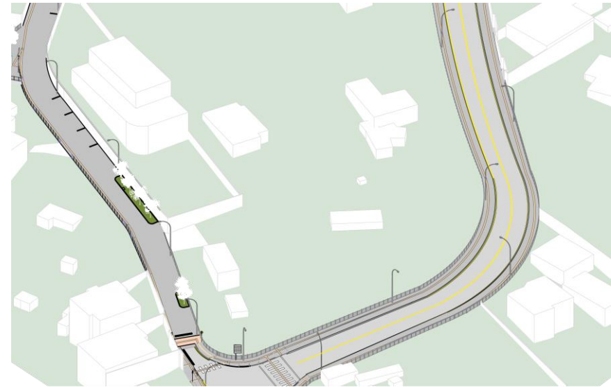
Figura 145. Estrategia de diseño de infraestructura vial - radios de giro Fuente: Elaboración propia
