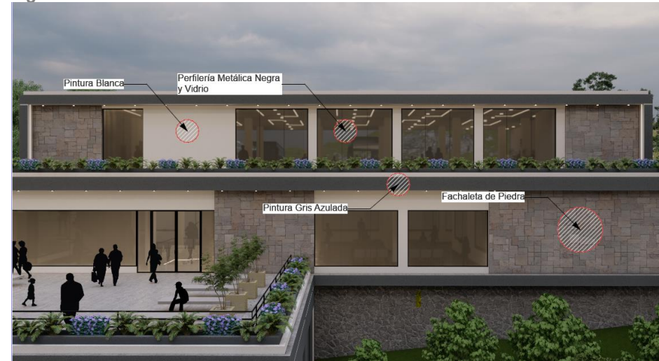
Figura 113. Materialidad en fachadas.
