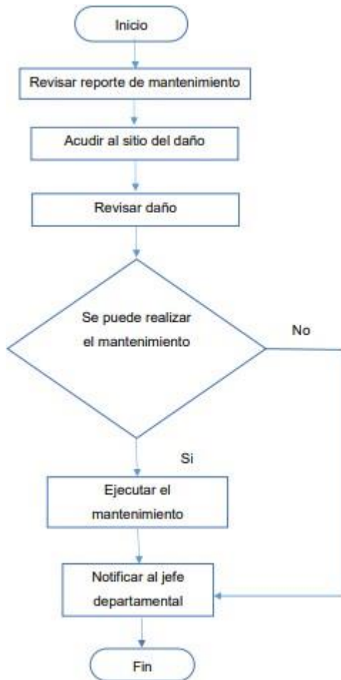
Figura # 13 Procedimiento de mantenimiento del Hotel Raymipampa
