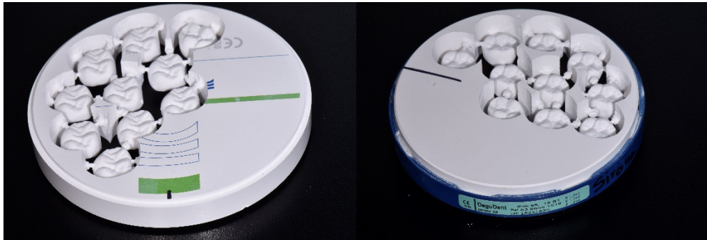
Figura 2. Restauraciones en discos CAD-CAM de dióxido de zirconio antes de sinterización.
