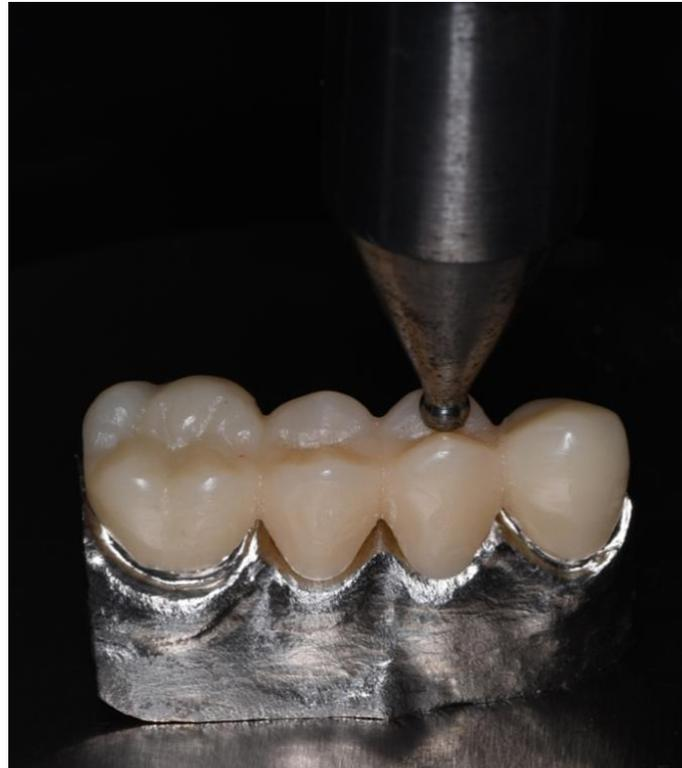
**Figura11.** Aplicación de pruebas de compresión en estructuras FDP, realizadas en una máquina de prueba universal
