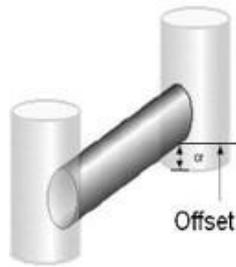
Figura 78. Esquema de alturas de salidas y llegadas de la tubería en los pozos de registro.
