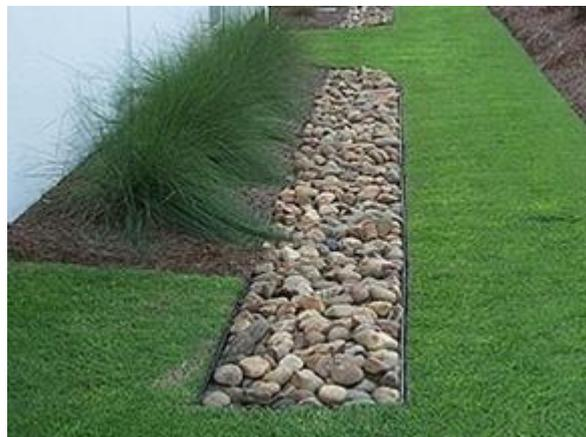
Figura 37. Zanjas de infiltración. Fuente: (Abellán, 2016c)
