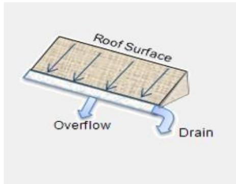
Figura 53. Esquema de la modelización de desconexión de bajantes en SWMM.
