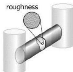
Figura 77. Esquema de la rugosidad que presenta el conducto.
