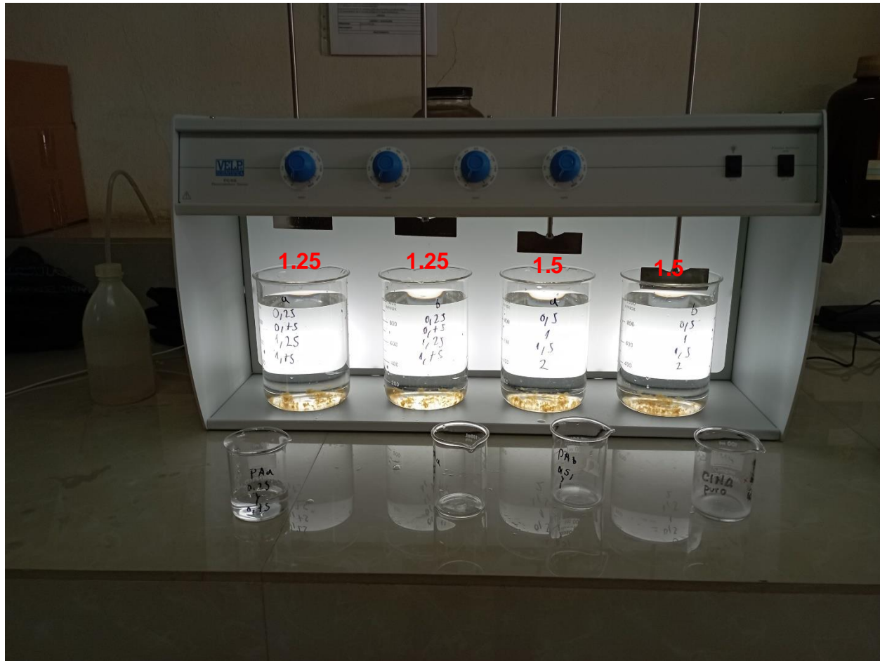
Figura 35. Pruebas de jarras usando el polímero aniónico (PA) con concentraciones de 1.25 y 1.5 ppm con duplicado.
