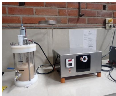
Anexo Y. Fermentación en el reactor tipo batch
