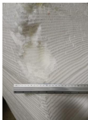
A4. Defecto en las esquinas
