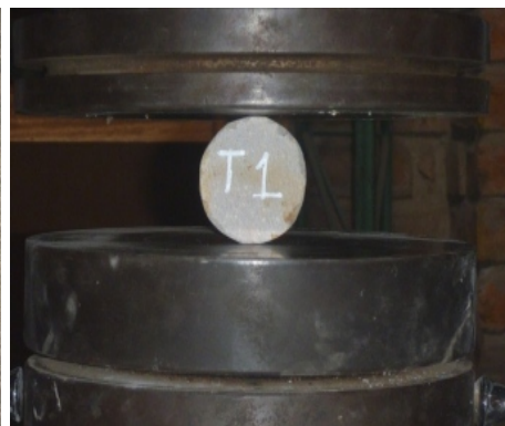
(b) Aplicación De La Carga
