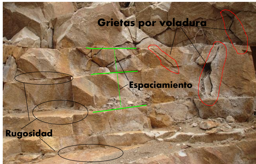
Figura 3.1.: Rugosidad, espaciamiento y alteración en las discontinuidades del macizo rocoso de la cantera “Las Victorias”
