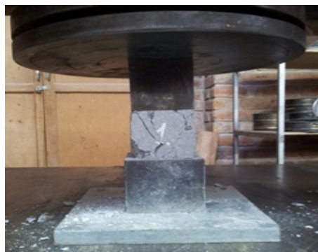
(c) Destrucción de la muestra
