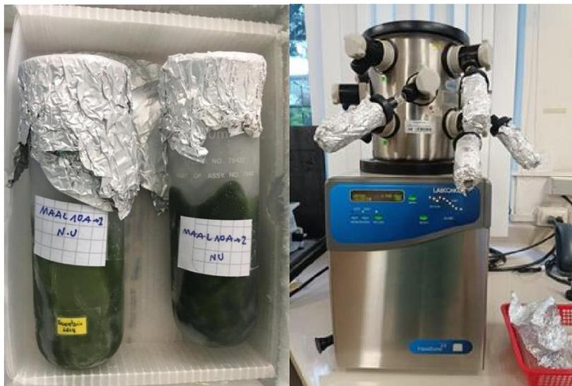
Nota. Figura a (izquierda): Elaboración de congelados. Figura b (derecha): Liofilización de la biomasa húmeda extraída.
