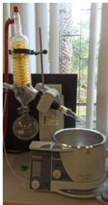
Anexo 2.4. Rotavapor marca Laborota 4000 Efficient de Heidolph ®
