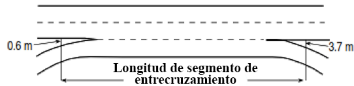
Ilustración 23 Longitud del segmento de entrecruzamiento, (HCM, 2000)
