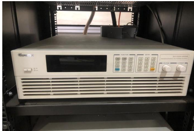
Figura 41. Fuente Controlada de Tensión y Corriente
