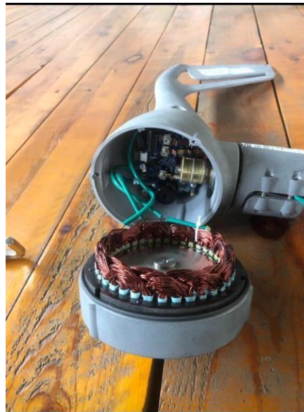
Figura 32. Generador, Estator Bobinado y Rotor de Imanes Permanentes.
