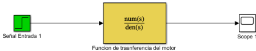
Figura 16. Sistema de validación de la función de transferencia en simulación.
