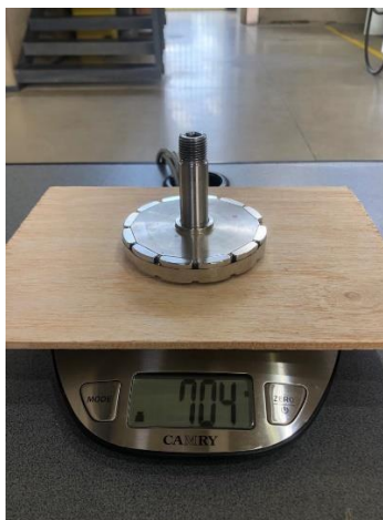
Figura 46. Pesaje del Rotor de Imanes Permanentes.
