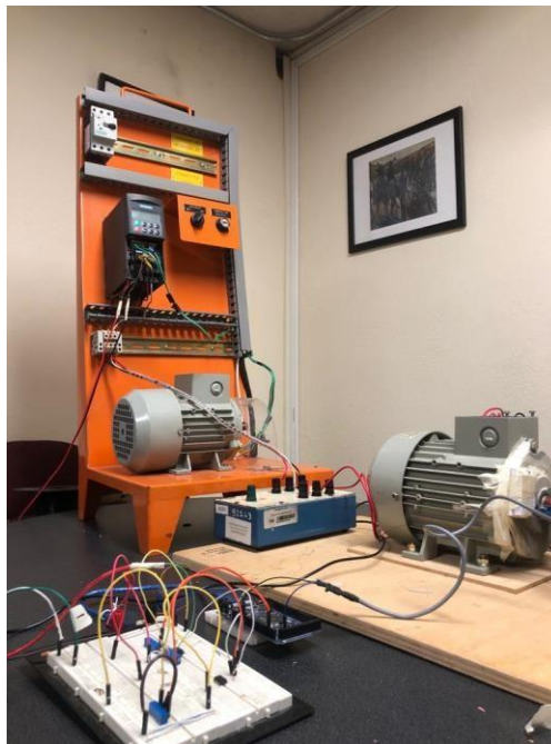
Figura 28. Implementación física del emulador eólico.
