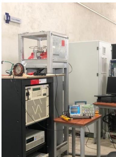
Figura 38. Banco de Trabajo para Pruebas de Circuito Abierto.
