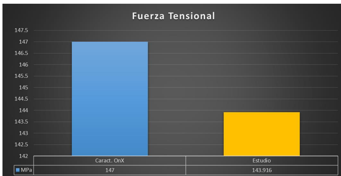
Figura 7 Relación de fuerza tensional del estudio realizado con características de la resina 3DPP dadas por el fabricante.
