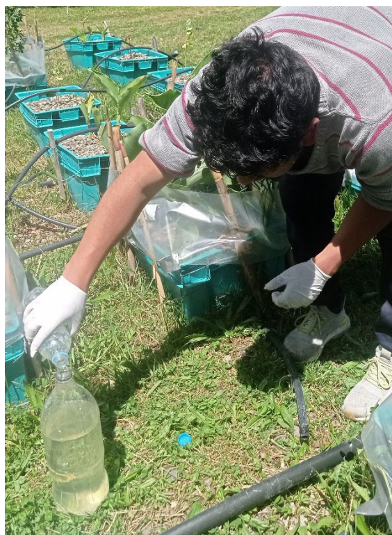
Figura 13: : Toma de muestras de agua de los HAFV con agua residual
