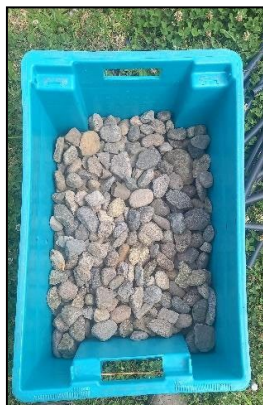
Figura 9: Colocación del medio filtrante en los humedales
