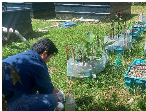
Figura 40: Toma de muestras de agua de los HAFV con agua residual
