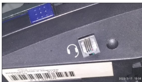
Figura 4.8: Puerto RJ9 del teléfono, modelo GN Netcom 7100, al que se le conectan auriculares con los cuales contestan las llamadas las operadoras del SIS ECU 911. Fuente: autor, 2023.
