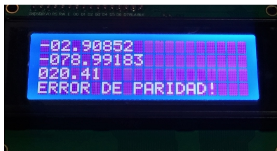
Figura 4.26: Despliegue de la ubicación en la pantalla LCD, con el mensaje de 'Error de Paridad'.
