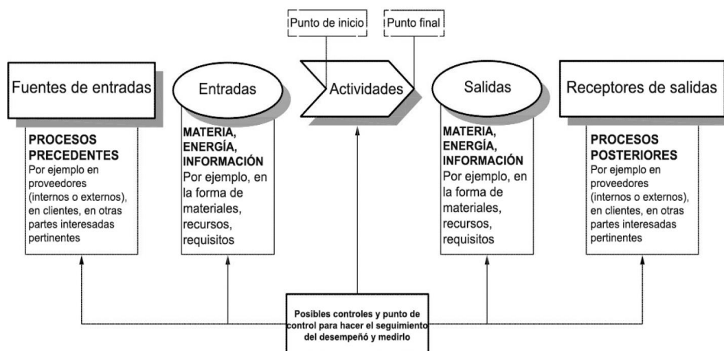
Figura 1. Representación esquemática de los elementos de un proceso. ISO (2015).
