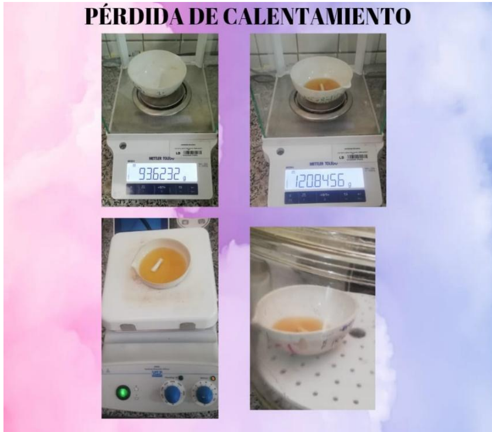
Figura 18 Determinación de la pérdida por calentamiento.
