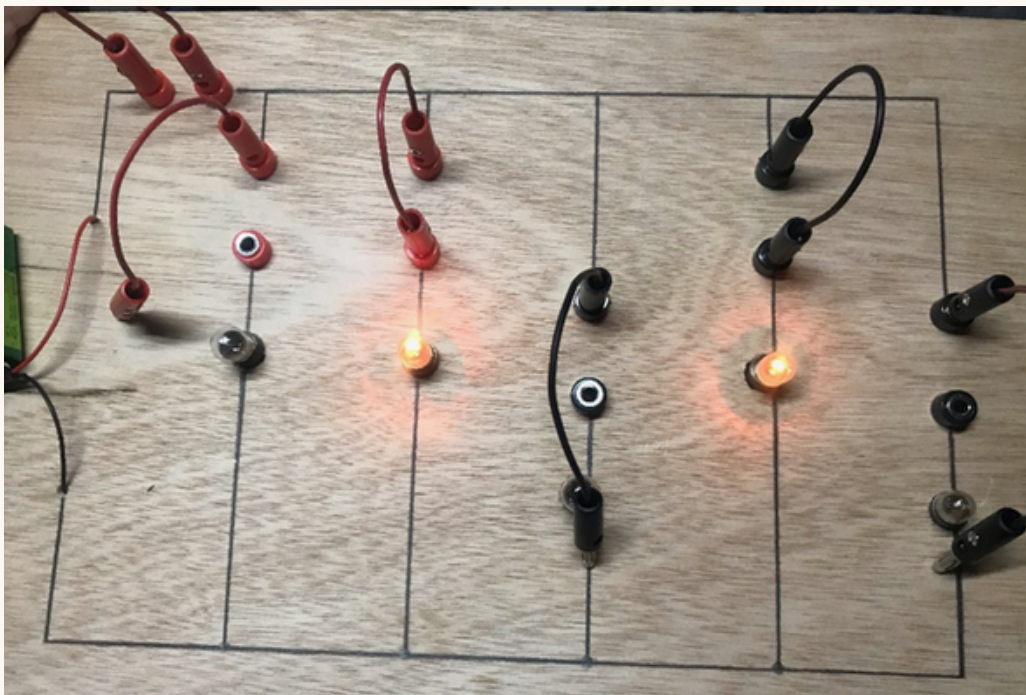
Figura 5 Circuito en paralelo, asociado con dos resistencias (2 focos.)
