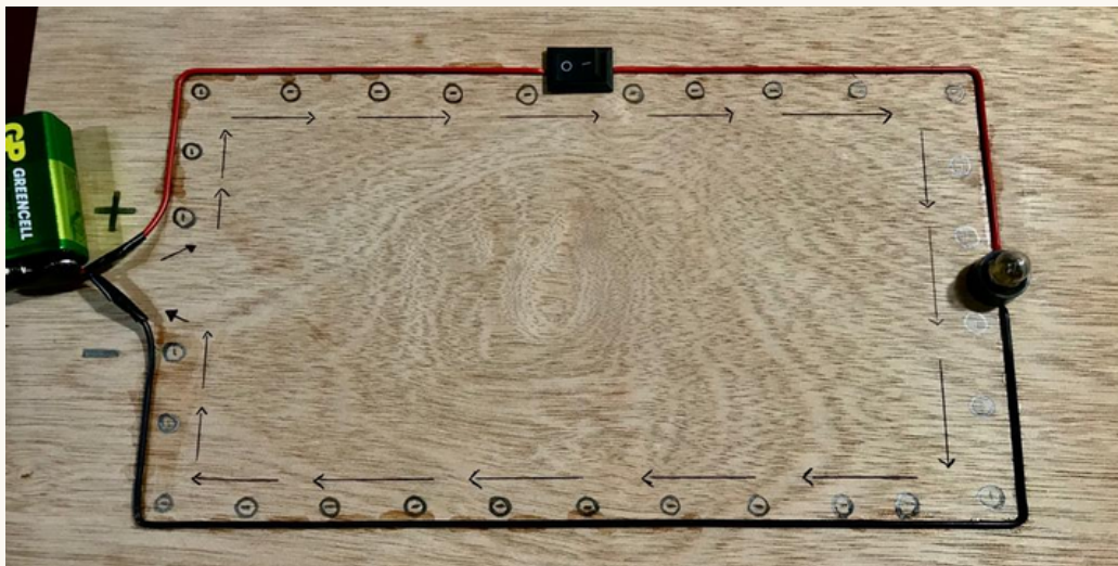
Figura 1 Circuito eléctrico simple (batería de 9 volt, interruptor, foco de 9 V.)
