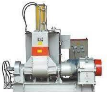
Figura 3. Mezclador cerrado con rotores internos (Banbury). Adaptado de Rubber Internal Mixer, Banbury Mixer , por s. f., CHENGBEN ( http://footwear-machine.com/1-3-rubber-internal-mixer-banbury-mixer.html ).
