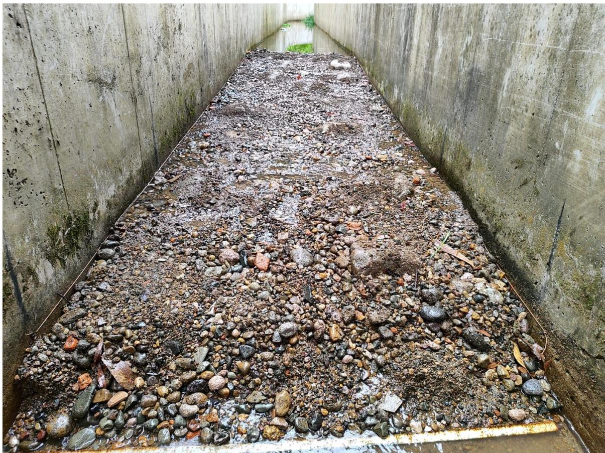
**Figura 13.** Conformación de capa de lecho móvil para experimentación en el canal multipropósitos del campus Balzay
