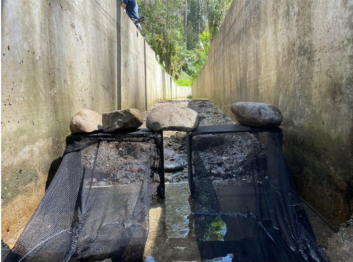
**Figura 16.** Colocación de trampas al final del tramo experimental para recolección de material transportado
