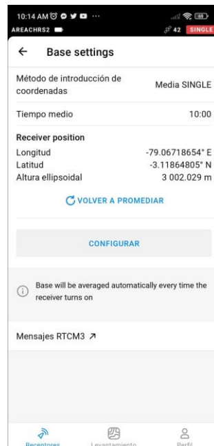
Figura 12. Configuración para la recepción de datos brutos (RTK) en los receptores GNSS Emlid Reach RS2 mediante aplicación móvil Emlid Flow
