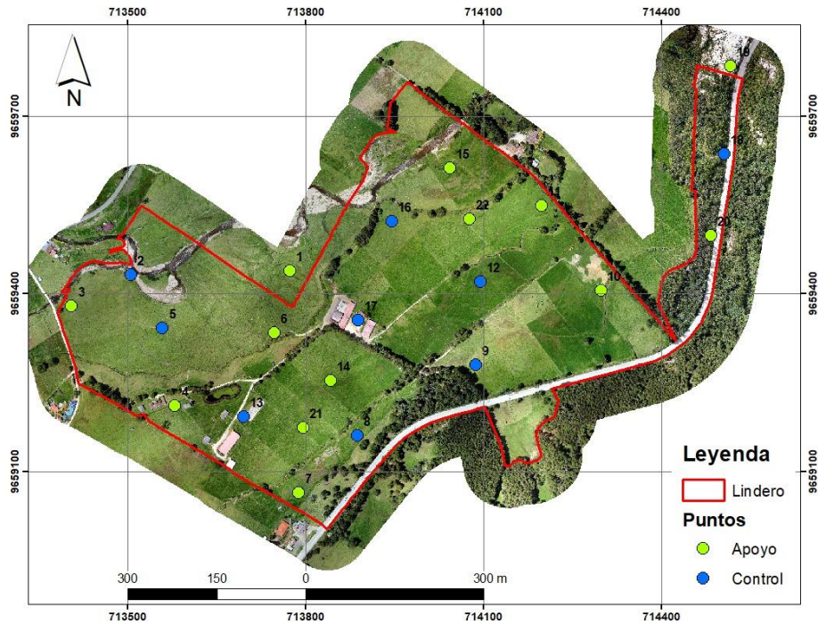
Figura 11. Distribución espacial de los puntos de apoyo y control en la Aplicación Locus Map
