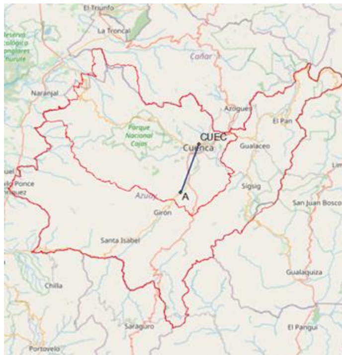
Figura 7. Línea base entre el Hito A y la Estación de Monitoreo Continuo (CUEC)
