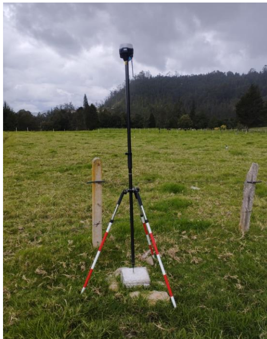
Figura 6. Configuración del equipo GNSS EMLID Reach RS2 con la aplicación móvil Emlid Flow
