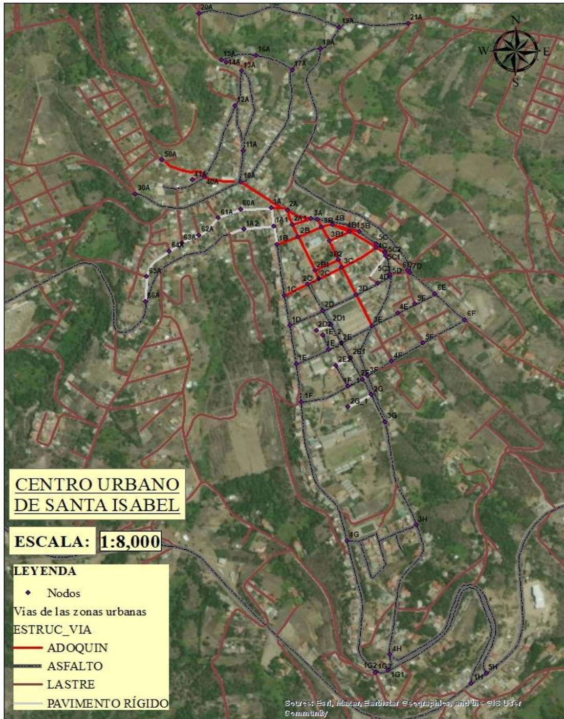
Figura 4. Mapa con nodos y diferentes pavimentos de Santa Isabel (PDOT de Santa Isabel, 2020)
