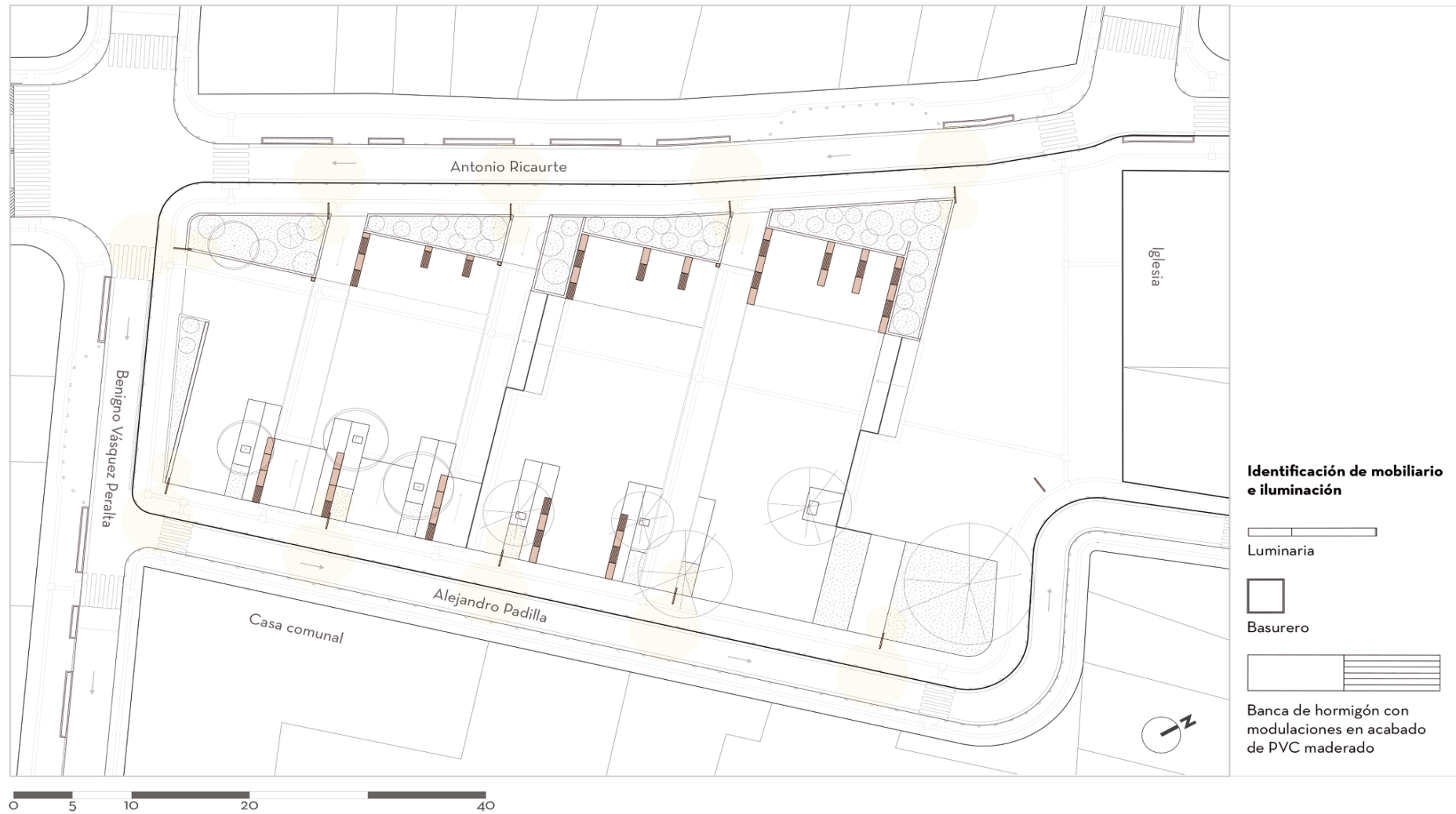
Figura 46. Planta de mobiliario propuesto
