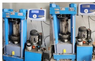
Figura 22: Ensayo rotura de Cilindros. (Resistencia a la compresión)
