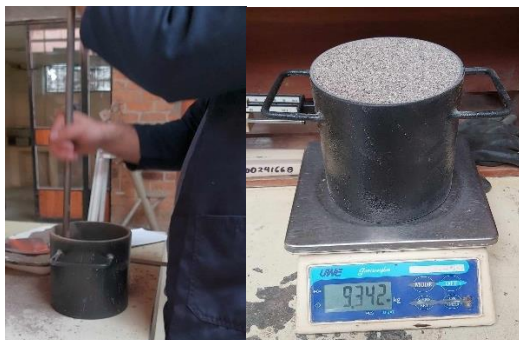
Figura 12: Procedimiento por varillado. (Masa Unitaria compactada)
