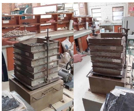
Figura 6: Proceso de tamizado del árido grueso.
