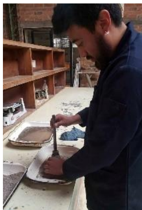
Figura 10: Compactación del árido fino para el estado SSS
