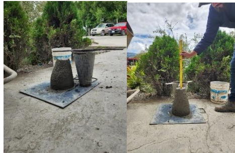
Figura 18: Ensayo de asentamiento.
