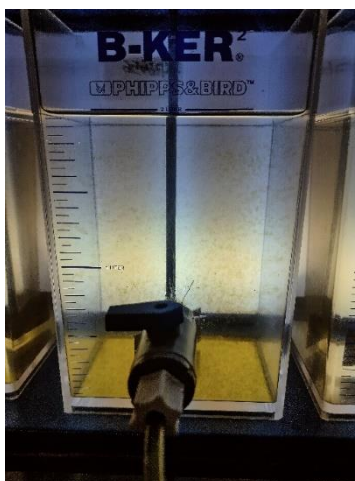
Figura 24. Análisis complementario en laboratorio, Ensayo de jarras.
