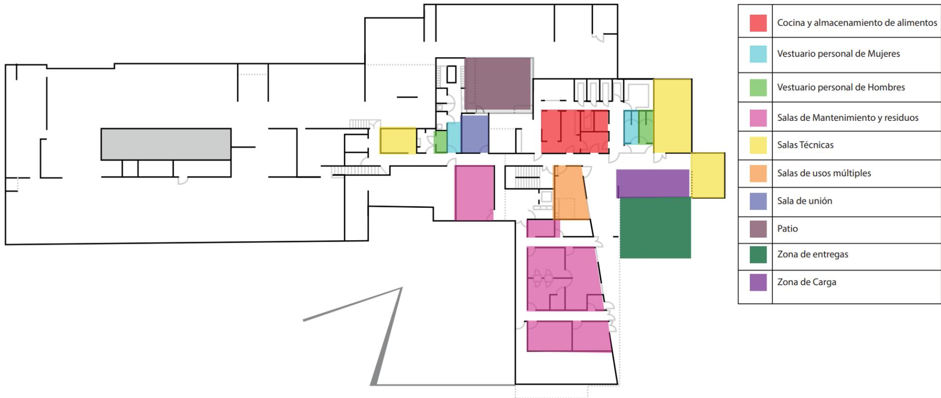
Figura 177 Zonificación planta sótano referente funcional.
