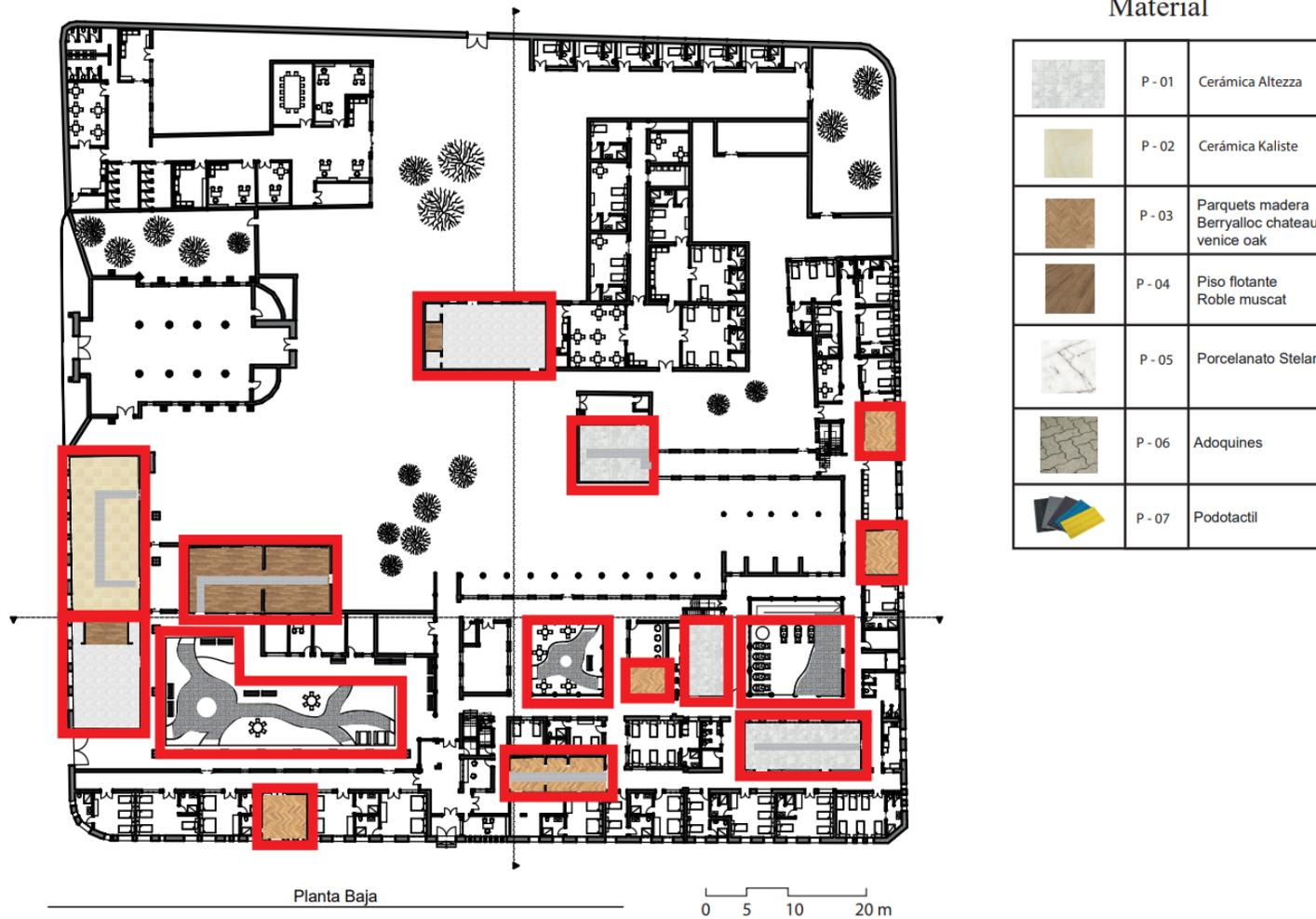
Figura 243 Planta baja pisos.
