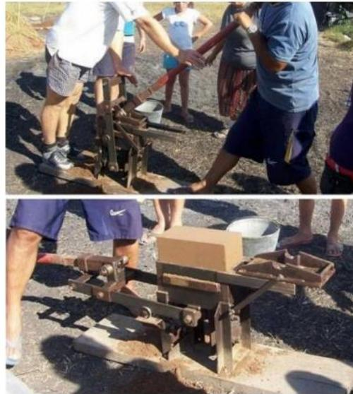
**Figura 4.** *Elaboración de bloques de tierra comprimida*
