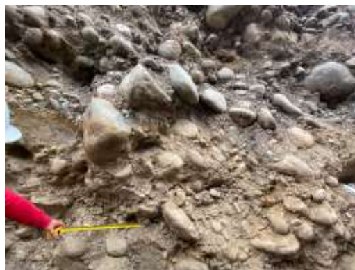
Figura 19. Fotografía #1 para determinar el porcentaje de boleos del talud. Fuente: Autor
