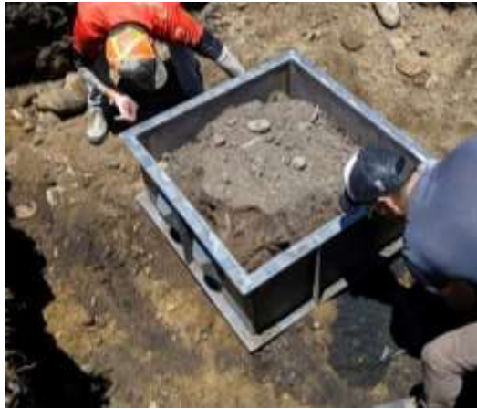
Figura 13. Ensayo de corte directo realizado en campo en la ciudad de Cuenca. Fuente: (Alvarez y Contreras, 2019)
