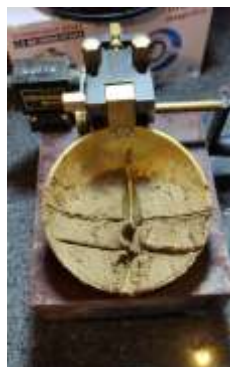
Figura 28. Sección de material que se toma para obtener la humedad en el ensayo de Casagrande. Fuente: Autor.
