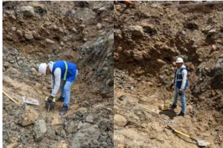
Figura 31 Toma de densidades con densímetro ubicada al pie del talud donde existe un menor porcentaje de boleos. Fuente: Autor.
