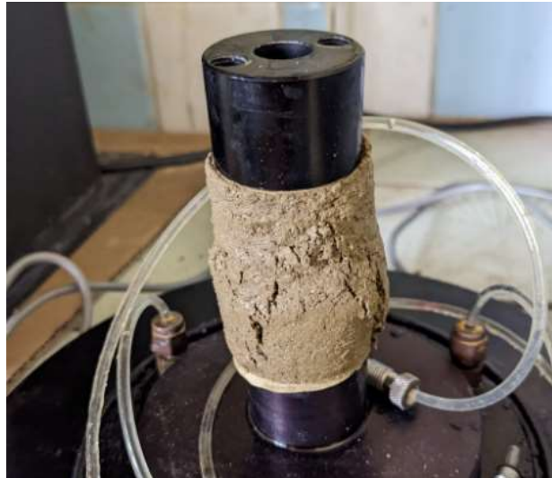
Figura 37. Muestra luego de ensayo a compresión simple. Fuente: Autor.
