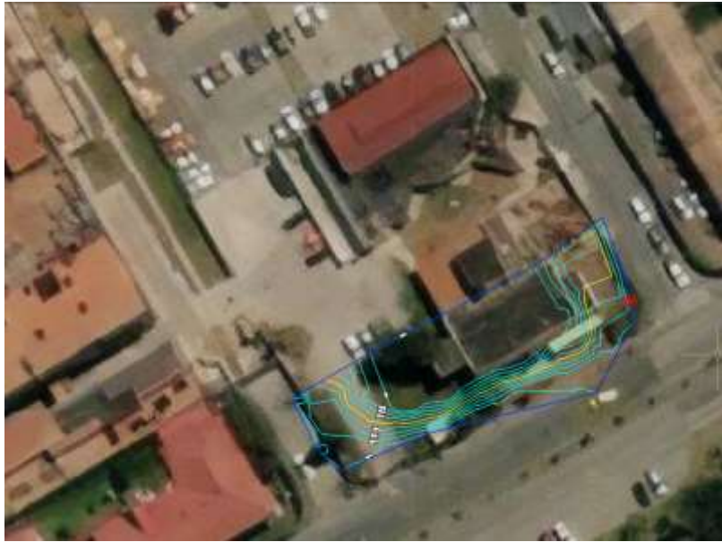
Figura 41. Ubicación del levantamiento topográfico en el mapa para determinar puntos de control y empatar ambos levantamientos. Fuente: Autor.
