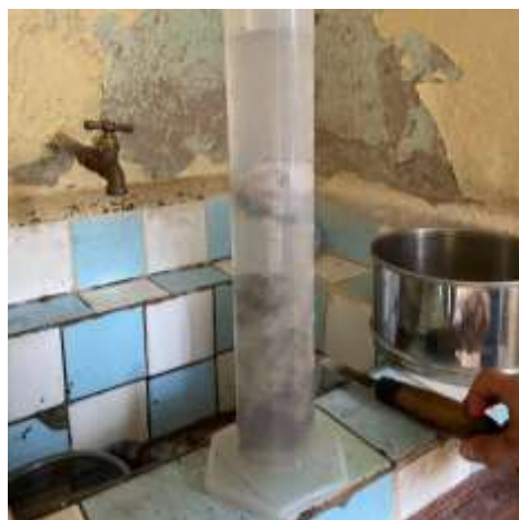
Figura 34 Muestras con parafina dentro de la probeta para determinar su volumen. Fuente: Autor.
