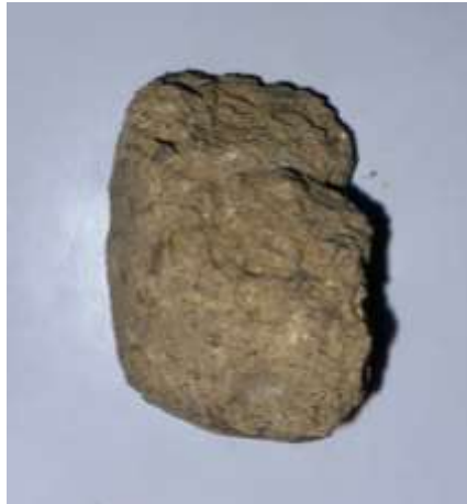
Figura 17. Pedazo intacto de la matriz del talud cubierto con parafina. Fuente: Autor
