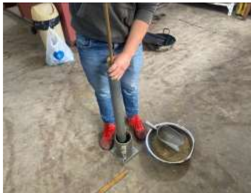
Figura 35. Compactación para ensayo Proctor. Fuente: Autor.
