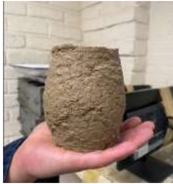
Figura 39 Muestra de suelo ensayada den Triaxial CU, falla tipo barril. Fuente: Autor.
