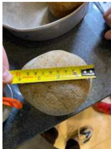
Figura 24. Complementación del análisis granulométrico con la ayuda de flexómetro para los boleos superiores a 3". Fuente: Autor.
