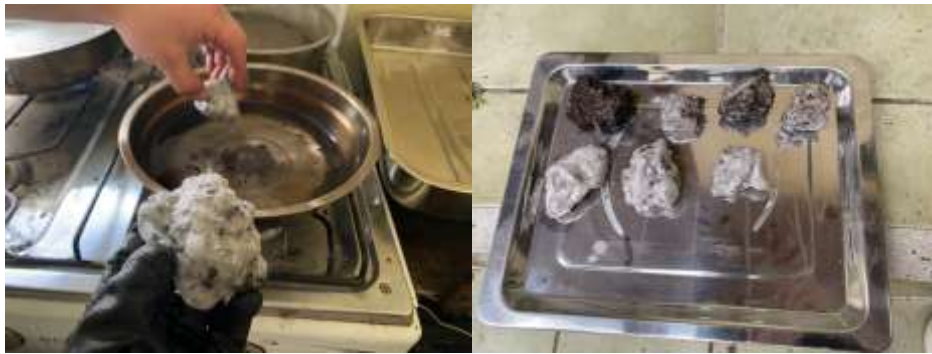
Figura 33 Ensayo de parafina, recubrimiento de muestras. Fuente: Autor.
