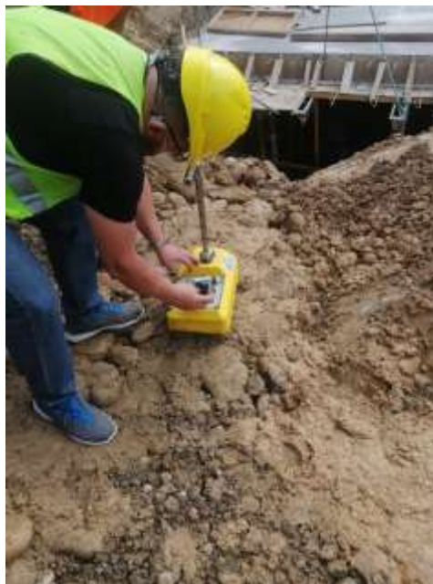
Figura 30. Primera toma de densidad con densímetro nuclear en material saturado, se puede observar la gran presencia de boleos en la zona. Fuente: Autor.
