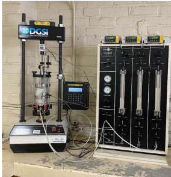
Figura 38 Equipo completo de triaxial, con la celda y el panel de control de presiones y niveles de agua. Fuente: Autor.
