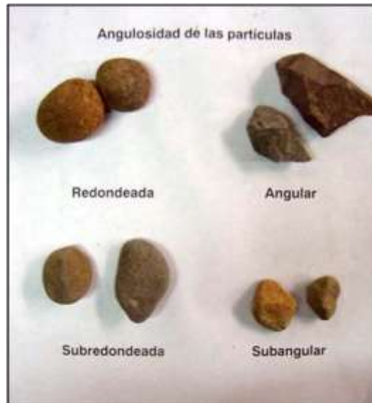
Figura 4. Diferentes tipos de formas de partículas. Fuente: (Angelone y Garibay, 2020).
