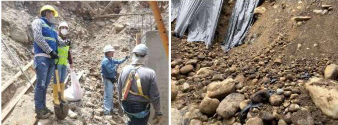
Figura 15. Toma de muestras del material para análisis granulométrico desprendido directamente del talud. Fuente: Autor
