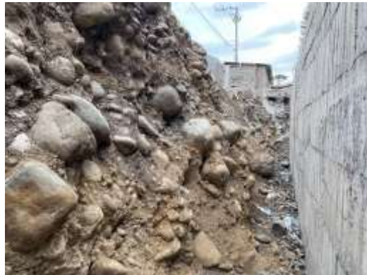
Figura 18. Parte del talud donde se tomaron fotografías para análisis de boleos. Fuente: Autor
