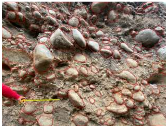
Figura 25. Proceso manual de identificación de boleos con diámetros mayor a 3". Fuente: Autor.
