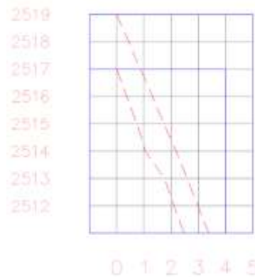
Figura 61. Superficie de falla obtenida, con geometría irregular debido al desprendimiento de boleos. Fuente: Autor.
