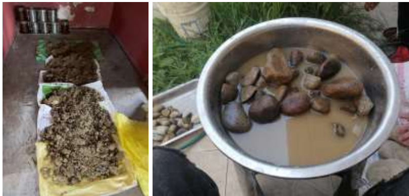
Figura 22. Proceso de secado al ambiente y lavado del material para análisis granulométrico. Fuente: Autor.
