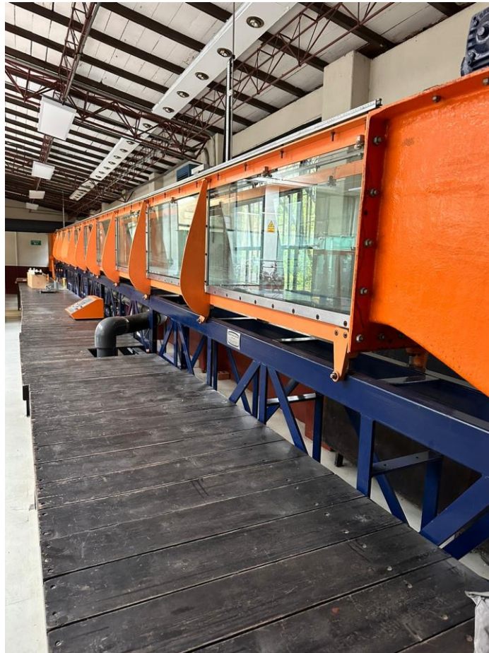
Figura 13. Canal del Laboratorio de Hidráulica de la Facultad de Ingeniería de la Universidad de Cuenca.
