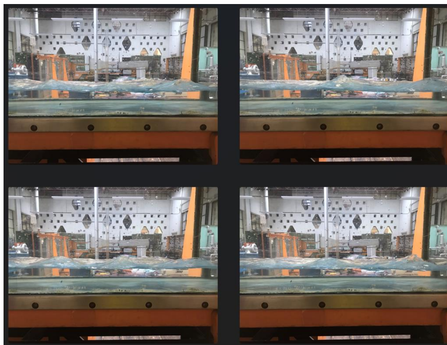
Figura 31. Ondulaciones que se generaban cuando se tenía un S=0.5% y Q=8.95l/s.
