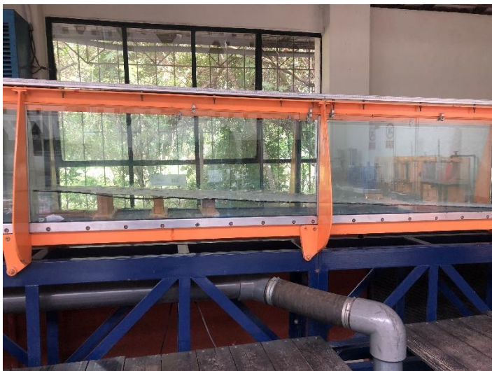
Figura 18. Fondo con rugosidad artificial colocado en el canal experimental.
