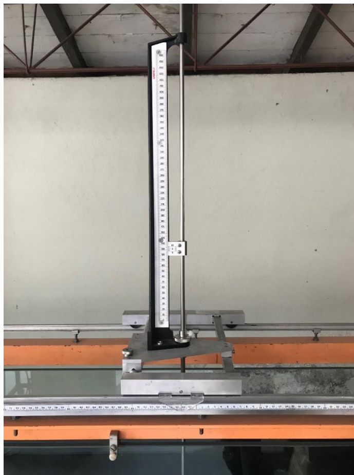
Figura 14. Limnómetros usados para tomar las medidas de altura dentro del canal de experimentación.
