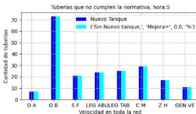
Figura 68. Comparación de tuberías que no cumplen la normativa, caso antiguo y actual con el nuevo tanque (05:00 am).
