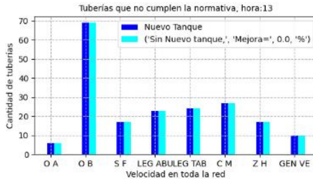
Figura 69. Comparación de tuberías que no cumplen la normativa, caso antiguo y actual con el nuevo tanque (01:00 pm). Fuente: Elaboración propia.
