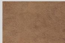
Acabado de pared empañetada con cal
