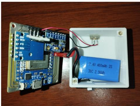
Figura 3.11: PCB y módulos utilizados en el prototipo 1
