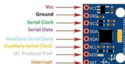
Figura 2.9: Definición de pines del sensor MPU6050 [7]
