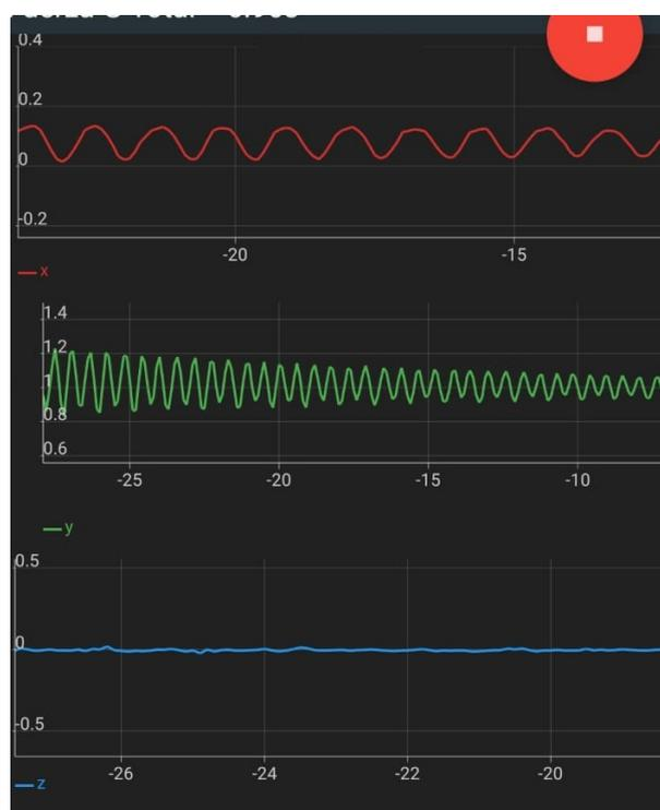
Figura 4.21: Componentes de aceleración de movimiento pendular (*smartphone*)
