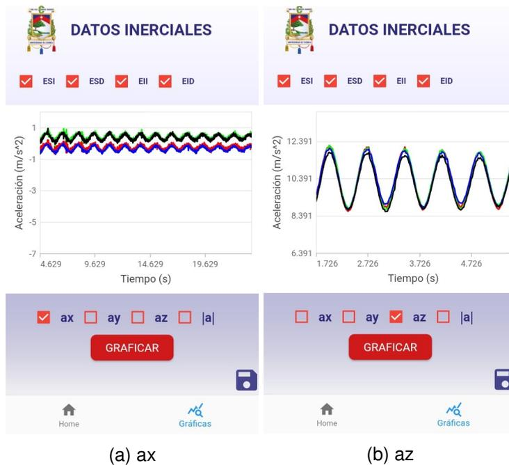
Figura 4.25: Componentes de aceleración en un péndulo, para los cuatro nodos sensores (aplicación móvil)
