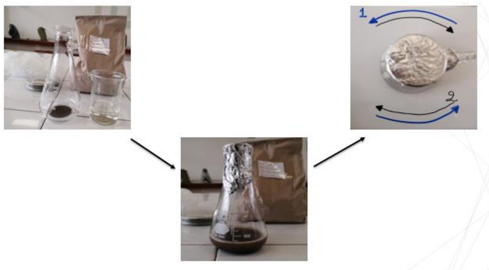
Figura 6. Proceso de la preparación de las soluciones
