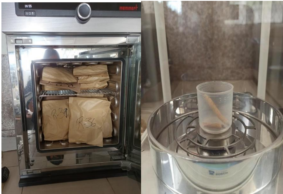
Anexo J. Proceso de secado por medio de la estufa (72°C) y medición del peso seco de las muestras de madera.
