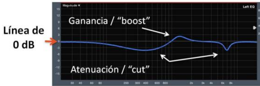
Figura 26. Magnitud / respuesta de frecuencia. Fuente: Acoustics, 2011.
