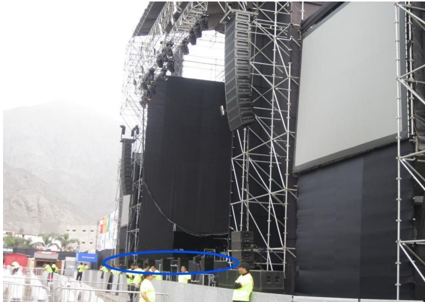
Figura 10. Subsistema de relleno Front fill. Fuente: Cabello, 2012.
