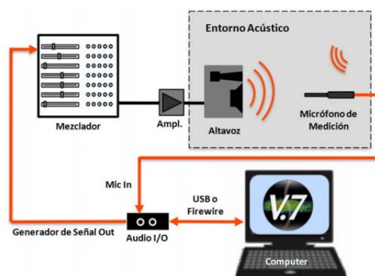
Figura 21. Diagrama de conexiones para smaart . Fuente: Acoustics, 2011.
