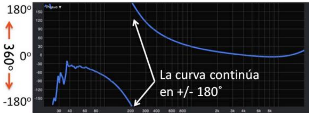
Figura 22. Curva de fase en función de transferencia. Fuente: Acoustics, 2011.
