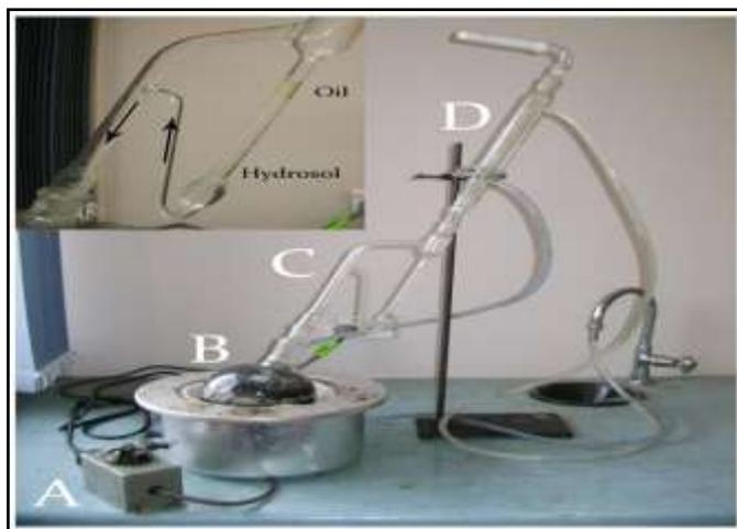
Ilustración 1. Destilación por arrastre de vapor. Tomado de (Sadgrove & Jones, 2015) (A) Regulador de potencia; (B) Manto calefactor con matraz de fondo redondo que contiene agua y la muestra; (C) Aparato del tipo Clevenger; (D) El condensador.
