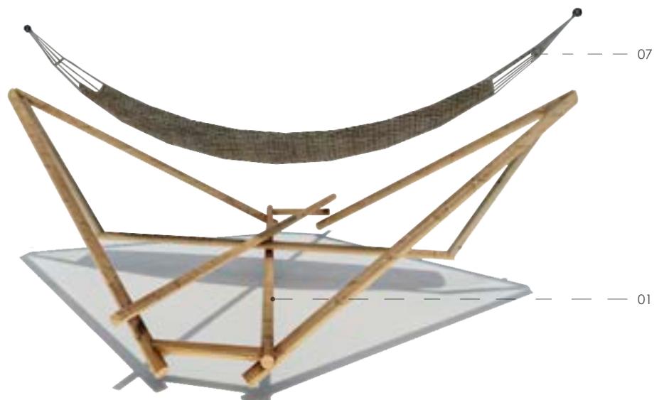
DETALLE BASE DE CAÑA GUADÚA EMPERNADAS ESCALA 3/4
