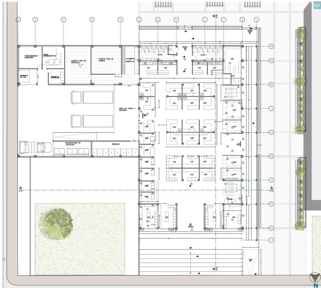
PLANTA BAJA CON ASCENSOR
