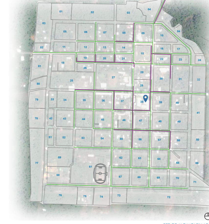
RED DE ALCANTARILLADO Esc: 1/12000
