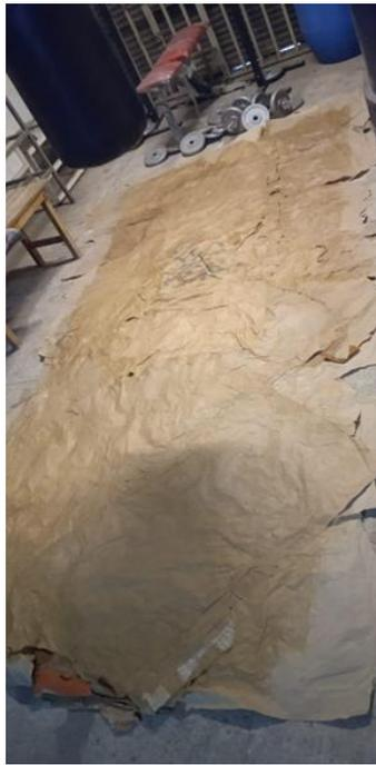
Imagen 22. Construcción de Lienzo a partir de la unión y superposición de sacos de cemento con pegamento (elaboración propia).
