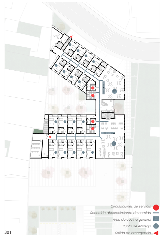
301 02. Circulación de cocina y nutrición Planta alta
