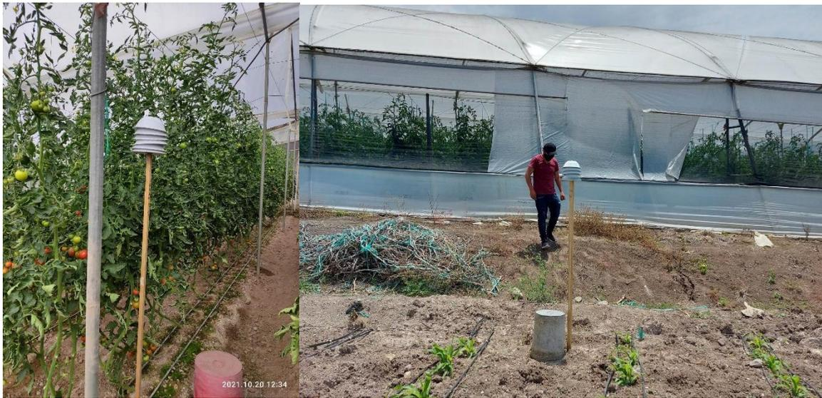
Instalación de los sensores Elitech RC-51 en el interior y exterior de los invernaderos.
