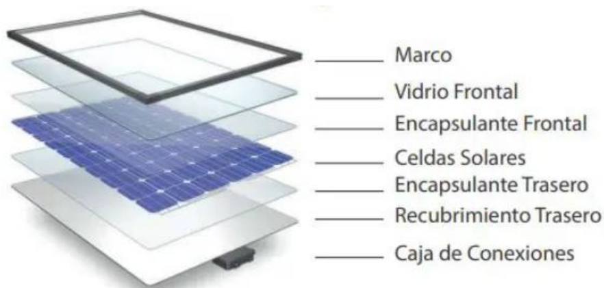
Figura 2.3: Partes de un módulo fotovoltaico (Seguí, s.f.).
