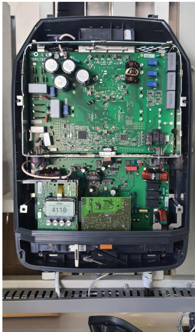
Figura 4.25: Elementos internos del inversor IFV3.
