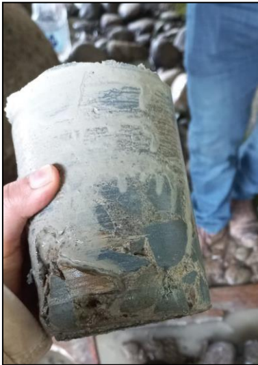
Imagen 46. Núcleo extraído en sitio
