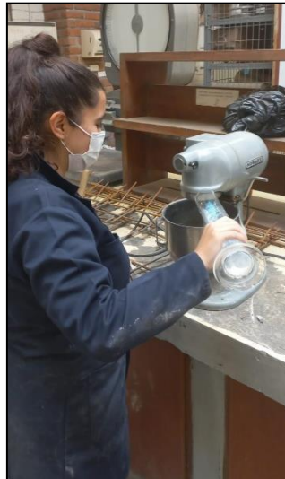
Imagen 47. Preparación de mortero de reconformado
