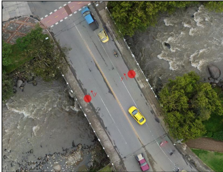
Imagen 90. Ubicación de las lecturas, ensayo Nakamura.
