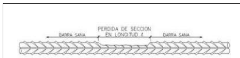
Imagen 150 Pérdida de sección por corrosión.
