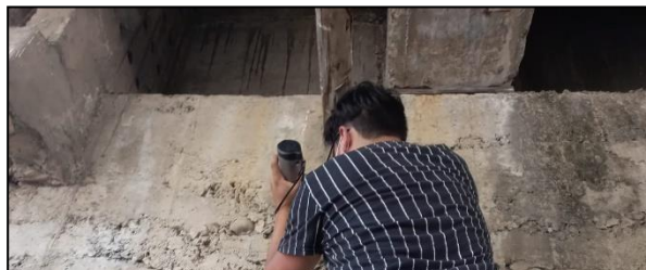
Imagen 68. Toma de datos con el esclerómetro en los estribos.
