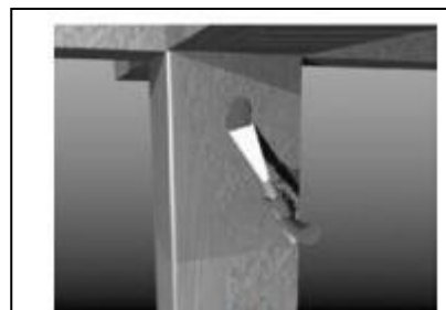
Imagen 181 Regularización de la superficie con mortero tixotrópico Fuente: (Machado, 2002)
