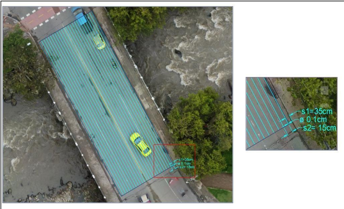
Imagen 125. Diagrama varillas longitudinales en la plataforma del puente.
