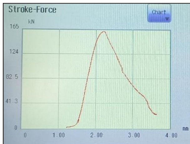
Imagen 115. Curva fuerza- deformación, Estribo izquierdo II.
