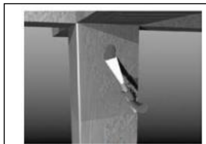
Imagen 172 Regularización de la superficie con mortero tixotrópico Fuente: (Machado, 2002)
