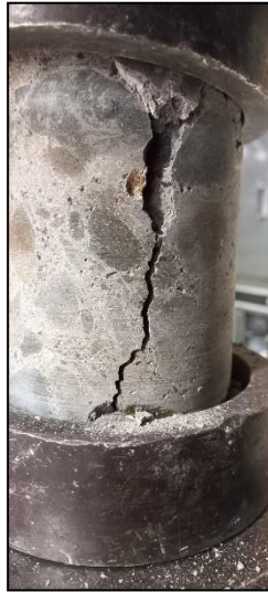
Imagen 114. Falla Núcleo del estribo izquierdo I.
