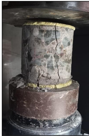
Imagen 110. Falla Núcleo del estribo derecho.
