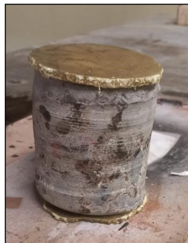
Imagen 50. Núcleo ya con azufre antes de colocar en la prensa.
