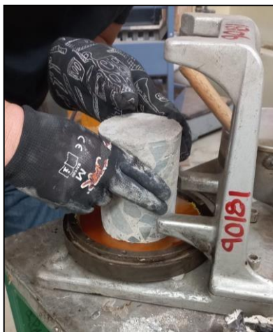
Imagen 49. Colocación de azufre en núcleo extraído
