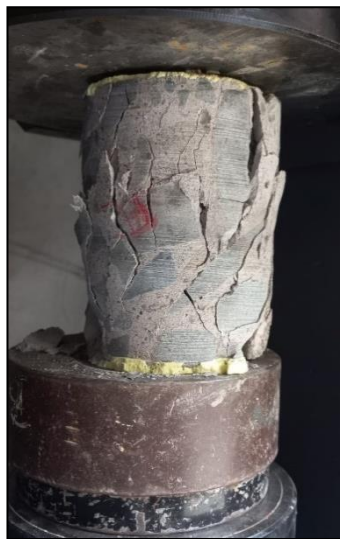
Imagen 113. Falla Núcleo del estribo izquierdo II.
