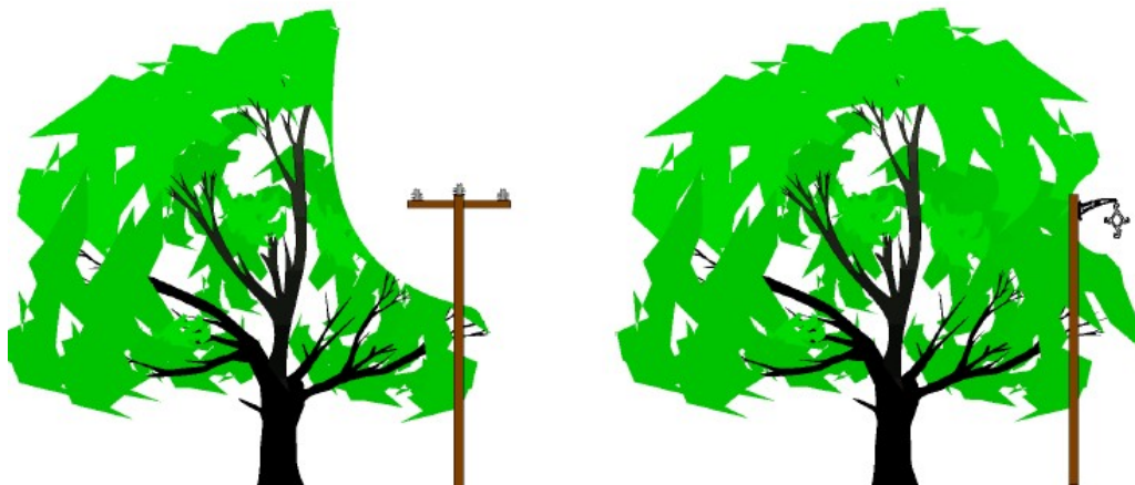
Figura 3.40: Comparación de la reducción del área de poda entre una red aérea de conductor desnudo y de conductor semiaislado [11].
