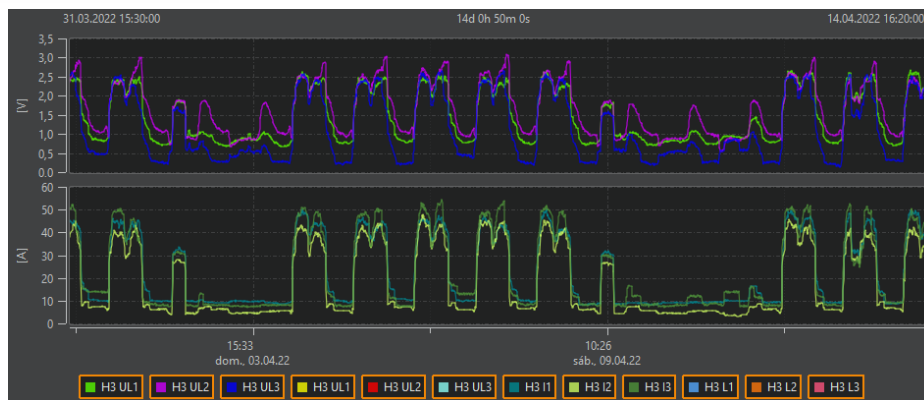
Figura 9. Mediciones de calidad procesadas en el software WinPQ mobil para el tercer armónico.
