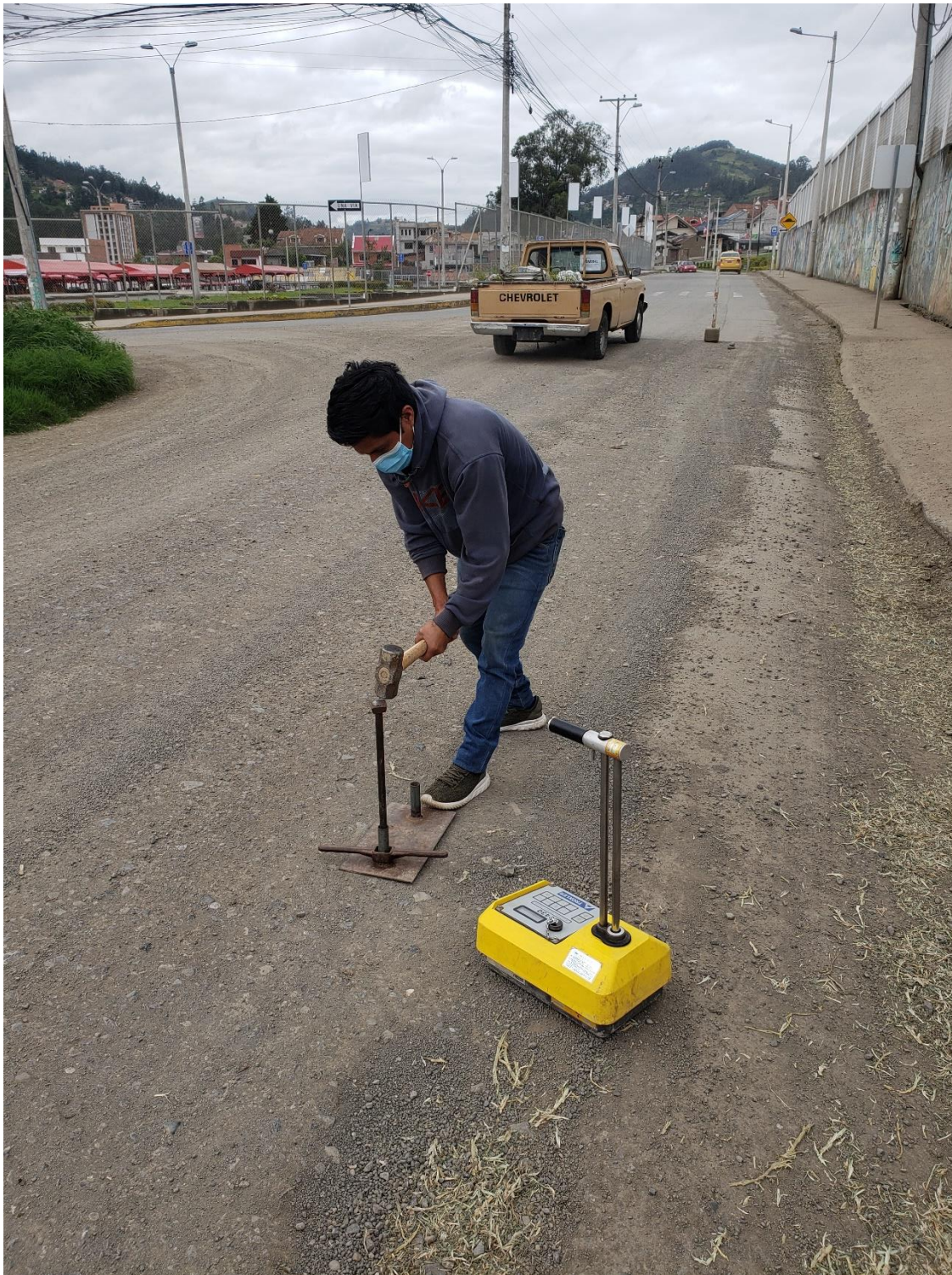
Foto 18. Toma de densidades con densímetro nuclear
