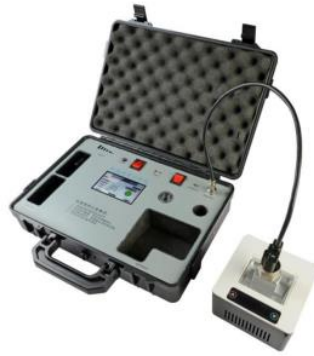
Figura 6. Analizador de aceite YTO. Universidad Politécnica Salesiana
