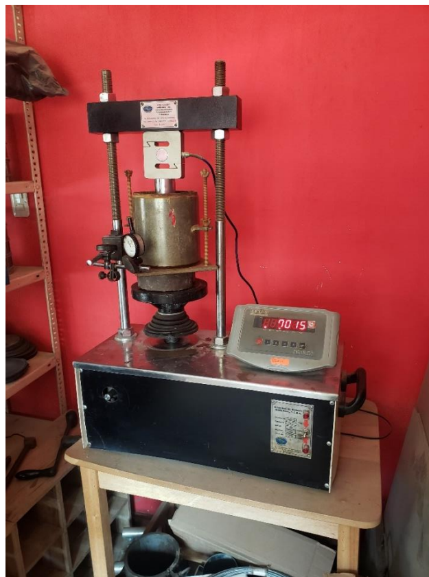
Foto 10. Penetración de muestras de CBR
